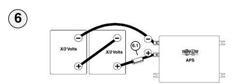
See Battery Connection, Pg.8. 6.1 is the fuse. X = Your APS's Inverter's Nominal Input Voltage. (See specs.) Refiérase a la sección "Conexión de Baterías", página 23. 6.1 representa el fusible. X = El Voltaje Nominal de Entrada del Inversor del APS. (Vea las especificaciones).
